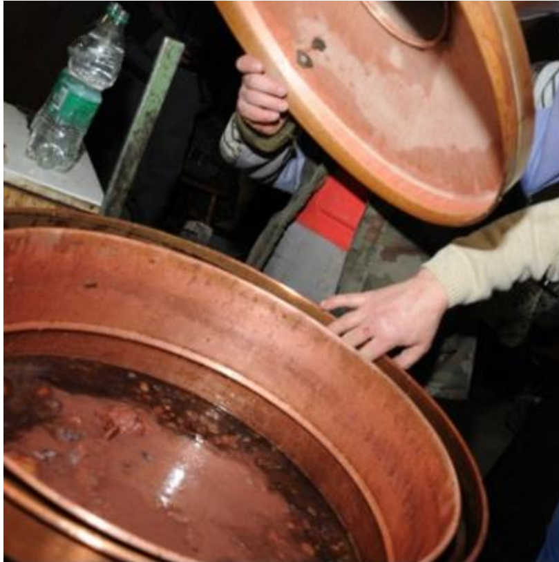
Slika 18: Kotel za žganjekuho
