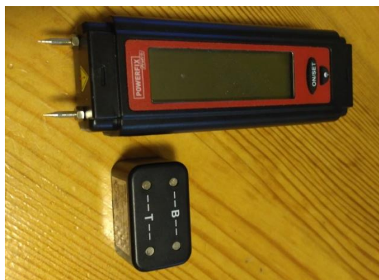
Fotografija 1: Merilec vlažnosti v lesu z nabijalnimi sondami
