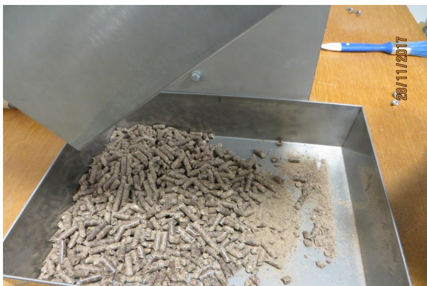
Fotografija 17: Vzorec peletov po tresenju v napravi za mehansko obstojnost
