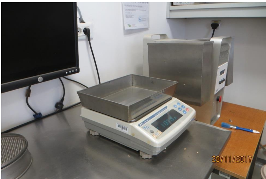
Fotografija 6: Tehnica s pladnjem in napravo za merjenje mehanske obstojnosti v ozadju
