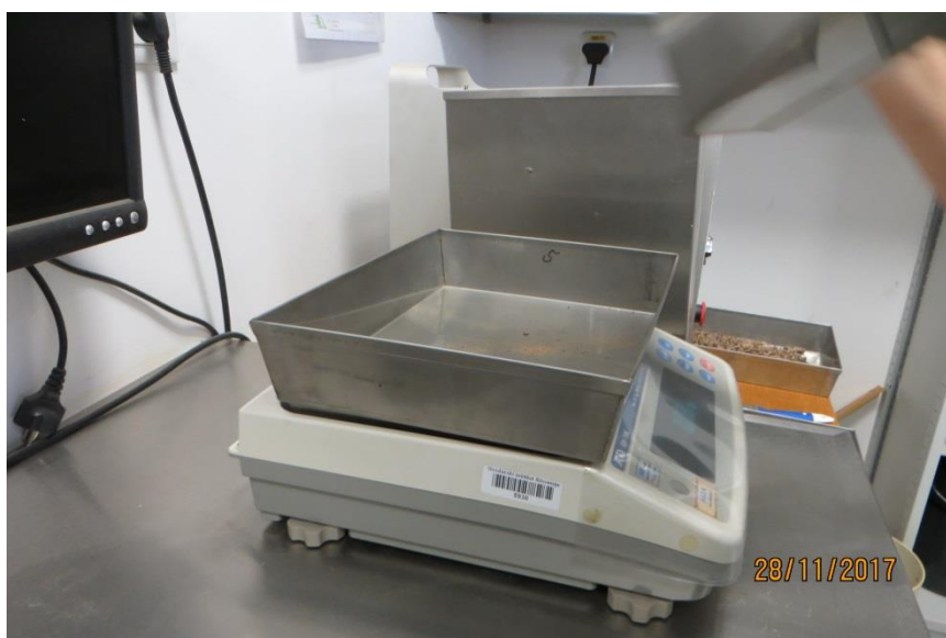
Fotografija 18: Tehtanje drobnih delcev pred analizo mehanske obstojnosti vzorca
