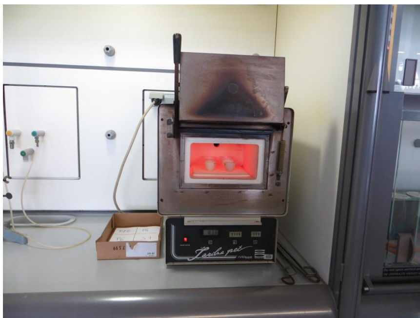
Fotografija 27: Keramični lončki z vzorci pri žganju v žgalni peči
