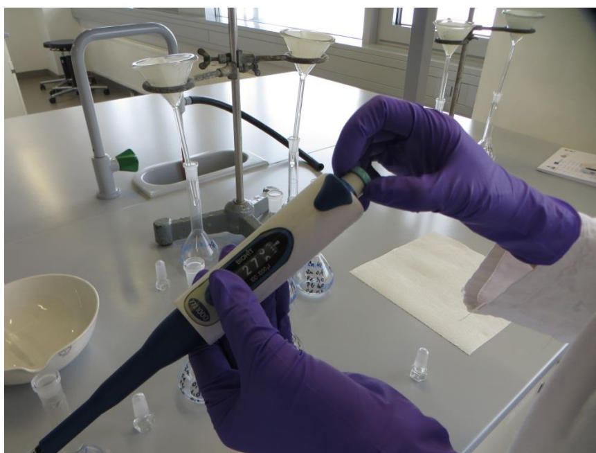
Fotografija 10: Nastavljanje volumna na avtomatski pipeti
