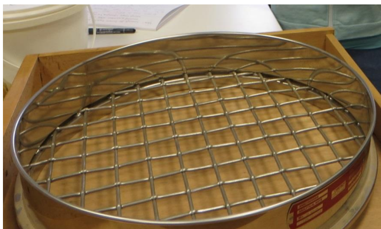
Fotografija 2: Sito za sekance (velikost odprtin 100 mm)
