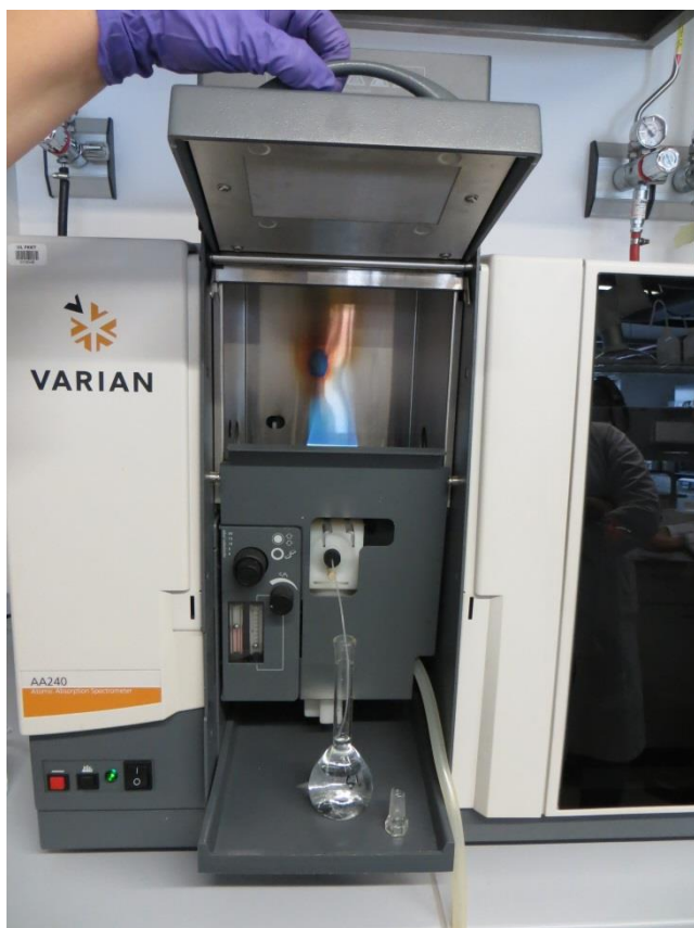
Fotografija 31: Analiza raztopine s spektrometrom. Na fotografiji je viden plamen, ki spojine razbije na atome.
