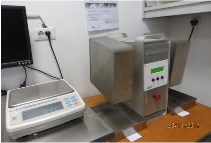
Fotografija 5: Naprava za preverjanje mehanske obstojnosti peletov v delovanju
